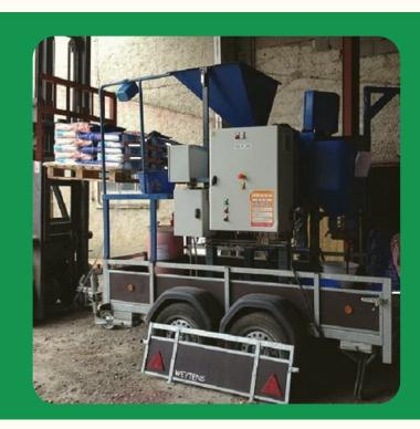
Installation de la machine BATCH avec un téléscopique et triphasée 380
