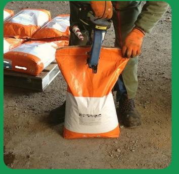
Reconditionnement des doses dans les sacs d'origine, fermeture et étiquetage
